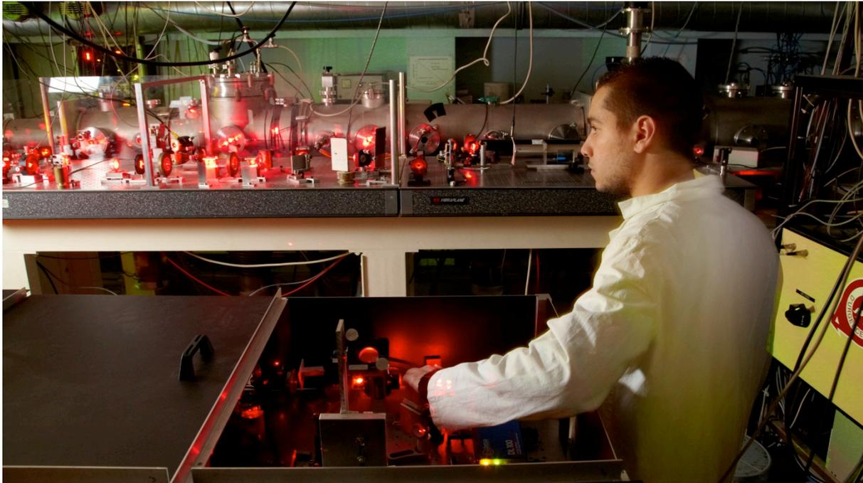
fig. 2 : interféromètre à atomes du LCAR - © Patrick Dumas/IRSAMC
